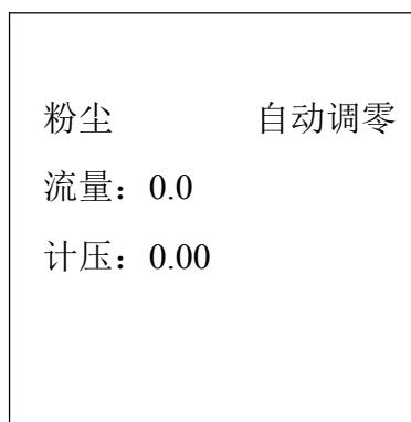
“自动调零”是对流量与计前压力的零点进行调整，每次采样必须先调零，点按“确认”仪器自动调零。
