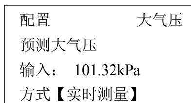
将光标移至“方式”点按“确认”选择“实时测量”还是“预测”后点按“取消”
